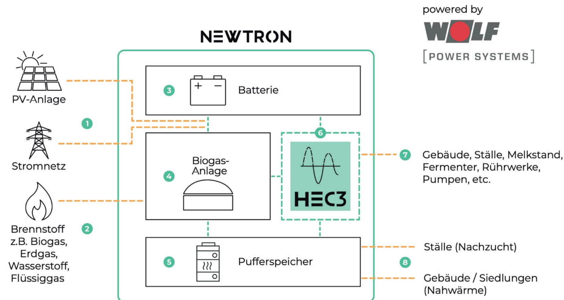
Das HEC3-Management ist das Herzstück und die standardisierte Schnittstelle zu den Energiekomponenten, welche bedarfsgerecht konfiguriert werden. Mit dem Energie-Management-System HEC3 werden Energieflüsse identifiziert und Flexibilitäten am Strommarkt aktiv vermarktet.
