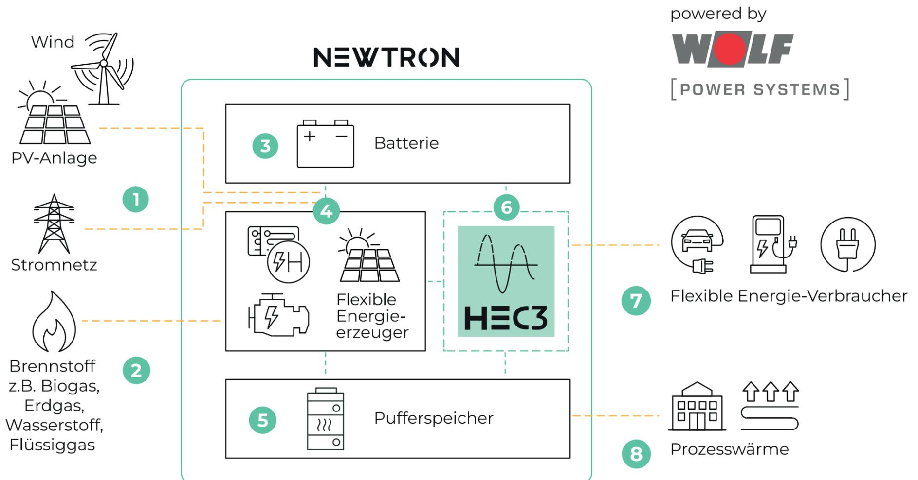
Das HEC3-Management ist das Herzstück und die standardisierte Schnittstelle zu den Energiekomponenten, welche bedarfsgerecht identifiziert und gesteuert werden. Mit dem Energie-Management-System HEC3 werden Energieflüsse identifiziert und Flexibilitäten am Strommarkt aktiv vermarktet.
